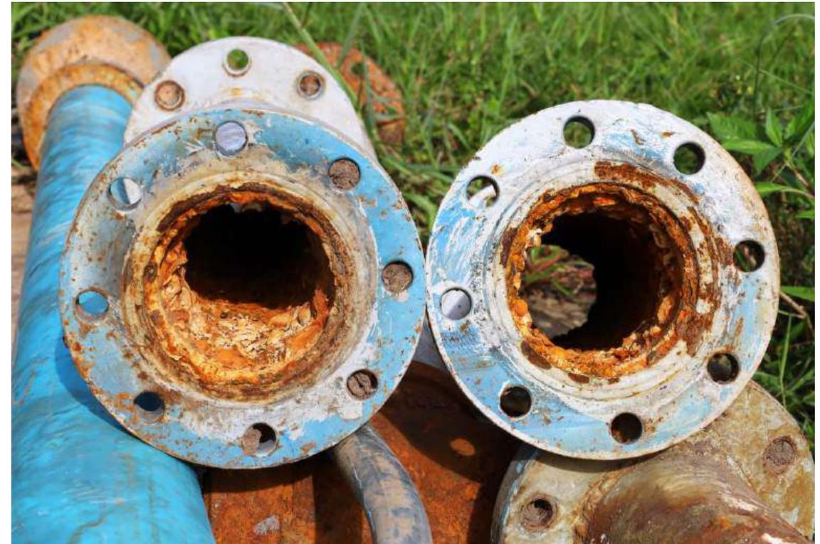
La condición de la acción corrosiva del fluido combinada con la acción abrasiva crea un efecto sinérgico devastador para la corrosión de los metales. Los tubos de fibra de vidrio, al ser inmunes a la corrosión y de alta resistencia a la abrasión, rompen el efecto sinérgico de este binomio, tan dañino para los materiales metálicos.
